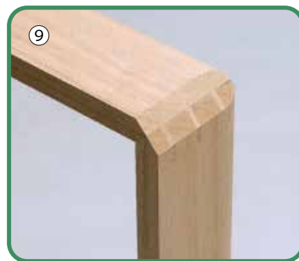
⑨ チギリを打ち込んでカットした状態
