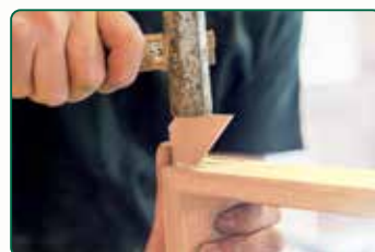
チギリを打ち込み強度を上げる
