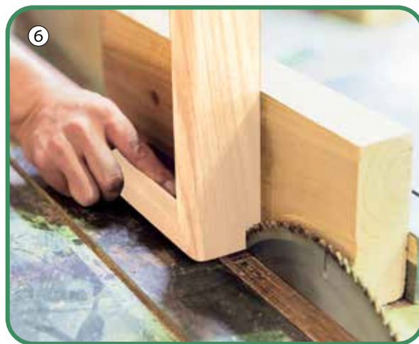
⑥ チギリを打ち込むため3mm巾の溝を切り込みを入れる
