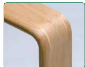
2度目の下地剤を塗装した状態
