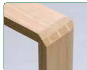
チギリを打ち込んでカットした状態
