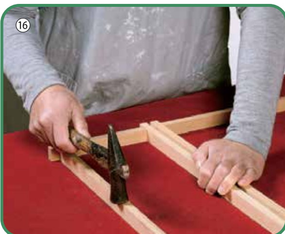
■ 中面骨組み作業
