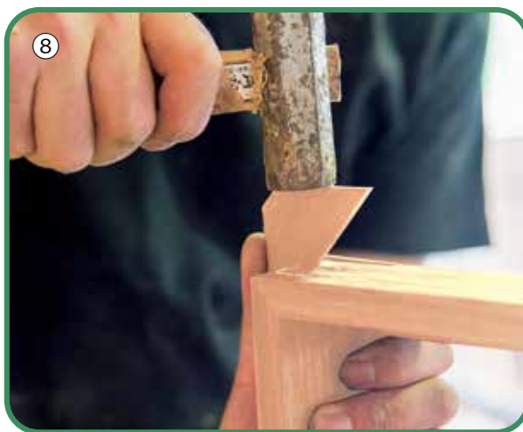
⑧ チギリを打ち込み強度を上げる
