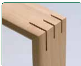
溝を切り込んだ状態
